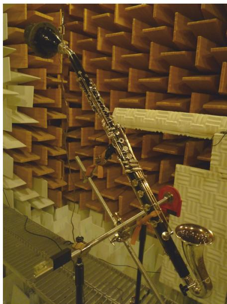
FIGURE 30 – Cor de basset en conditions de mesure
