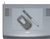
L'application du stylet sur la surface active déclenche l'envoi des données à l'ordinateur. La surface active repère la position. Le stylet possède une mine permettant de capter la pression exercée, un bouton latéral configurable mais non utilisé, et une gomme à l'autre extrémité, configurable, mais non utilisée.
