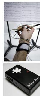
C'est un outil puissant est bien adapté aux nouvelles technologies de transmission de données, comme le WiFi, grâce à au protocole OSC. L'échantillonnage est beaucoup plus important qu'avec un contrôleur MIDI ce qui permet l'élaboration d'installations plus ambitieuses dans le cadre de la performance musicale temps-réel. Par ailleurs, outre la performance, cet outil a un intérêt pédagogique avéré (cf (Bevilacqua, Frédéric et al. 2007)).
