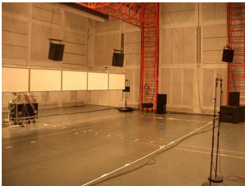
FIG. 4.10 – Campagne de mesures de haut-parleurs MAP (panneaux blancs) conduite dans l'Espace de Projection en avril 2005. A droite de la photographie, on peut voir des microphones Schoeps employés pour mesurer la réponse du banc de haut-parleurs.
