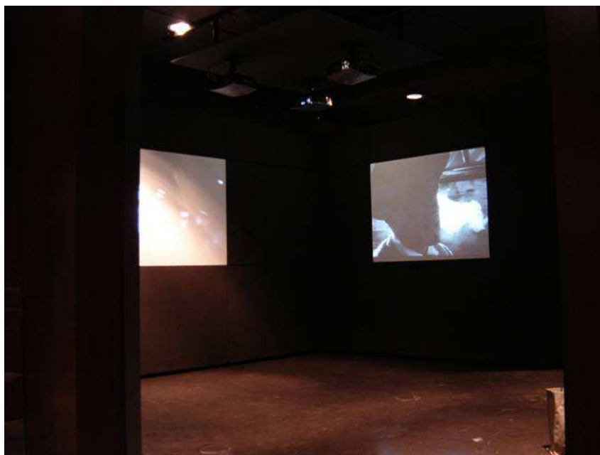
FIG. 1.29 – Installation sonore audio-vidéo utilisant la WFS dans l'exposition permanente de la Cinémathèque Française. Les haut-parleurs MAP sont situés derrière les écrans de projection en toile acoustiquement transparents.
