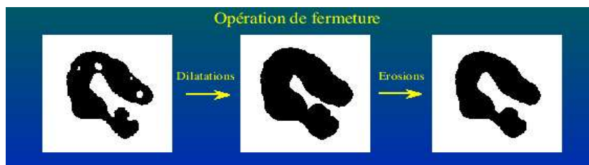
FIG. C.6 – Principe de la fermeture morphologique.
