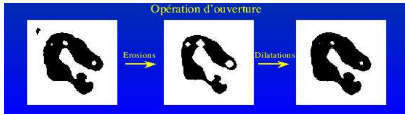
FIG. C.5 – Principe de l'ouverture morphologique.
