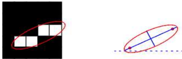
FIG. C.23 – Exemple de tache et d'ellipse associée.
