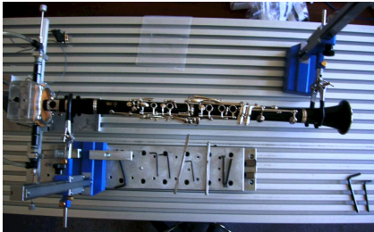
FIGURE 5 – Bouche artificielle MIAM-v2 et clarinette
