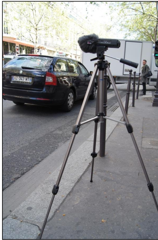
Figure 23 : Le H4n sur tripode positionné pour l'enregistrement, près d'un passage piéton, lieu privilégié des accidents
