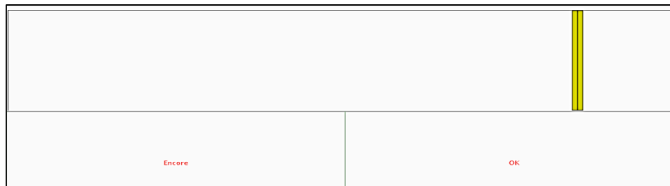
Figure 31 : Interface générée par Psiexp. L'auditeur déplace le curseur jaune de gauche à droite ou de droite à gauche pour ajuster le niveau du bruit blanc, plongé dans le bruit de fond, et le placer au seuil d'audibilité.
