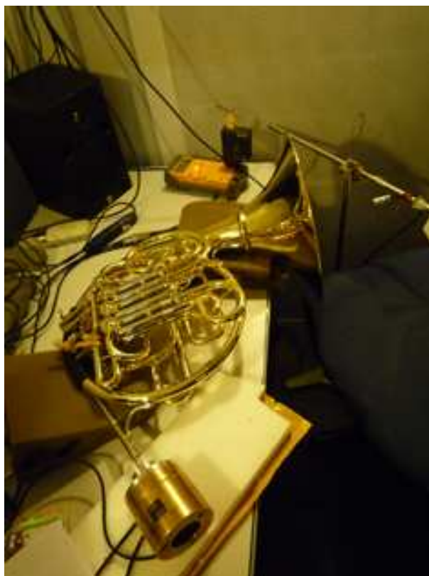
FIGURE 20 – Mesure d'impédance du cor
