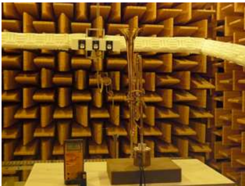
FIGURE 18 – Mesure d'impédance de la trompette
