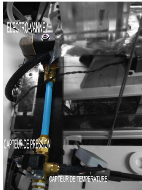
FIGURE 1.3 – Photographie de l'alimentation en air
