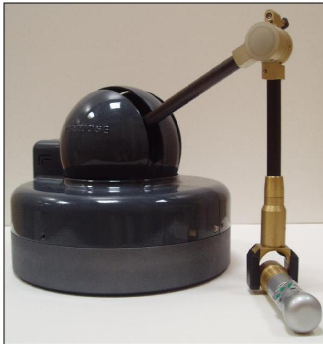
Figure 15 : Le VIRTUOSE 3D 15-25 d'HAPTION
