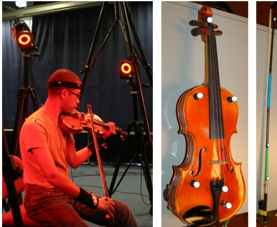
FIG. 2.1 – (gauche) : réseau de caméras rapides enregistrant un violoniste. (droite) : Placement des réflecteurs utilisé pour mesurer les mouvement du violon et de l'archet.
