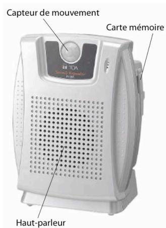
Figure 2. Enceinte (modèle TOA EV20A) utilisée pour la diffusion des sons de la signalétique sonore. Il s'agit d'une enceinte amplifiée muni d'une carte mémoire permettant de stocker un fichier son à diffuser. La diffusion peut être déclenchée par le capteur de mouvement intégré ou bien par un capteur externe (voir Figure 3).
