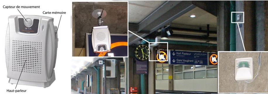
FIG. 8.9: Photo de gauche : enceinte (modèle TOA EV20A) utilisée pour la diffusion des sons de la signalétique sonore. Il s'agit d'une enceinte amplifiée munie d'une carte mémoire permettant de stocker un fichier son à diffuser. La diffusion peut être déclenchée par le capteur de mouvement intégré ou bien par un capteur externe. Photo de droite : enceinte posée (à gauche) et reliée à un capteur externe (à droite).
