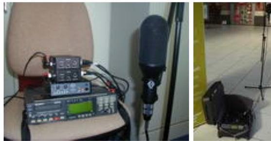
FIG. 5.2: Matériel utilisé pour les prises de son dans les gares. Photo de gauche : DAT, boîtier de traitement, les deux préamplis et le microphone Bformat. Photos de droite : tout le matériel rangé dans une valise.
